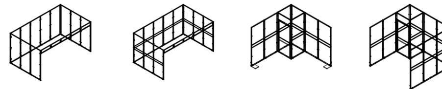
Als das erste Messesystem für Selbstmontage bietet OCTAwall einen abschließbaren Stauraum mit Tür, der selbstverständlich in der Größe variabel ist.
